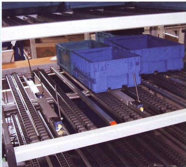
Bild 2 AMS-Erfassungsmodule für Rollenleisten im KLT-Durchlaufregal in einem Praxis-Einsatz in der Automobil-industrie.
