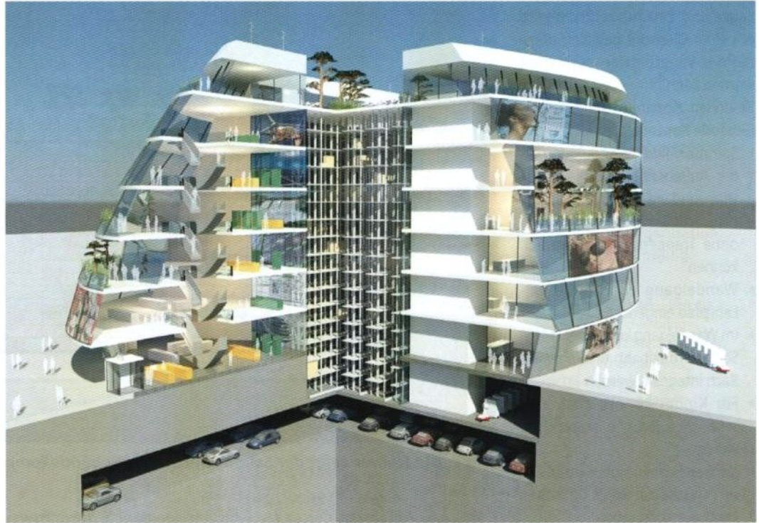
Bild 3: Um ein automatisches Hochregallager wird das Einkaufszentrum mit verschiedenen Ebenen gebaut – perspektivische Ansicht für den Gebäudekomplex
